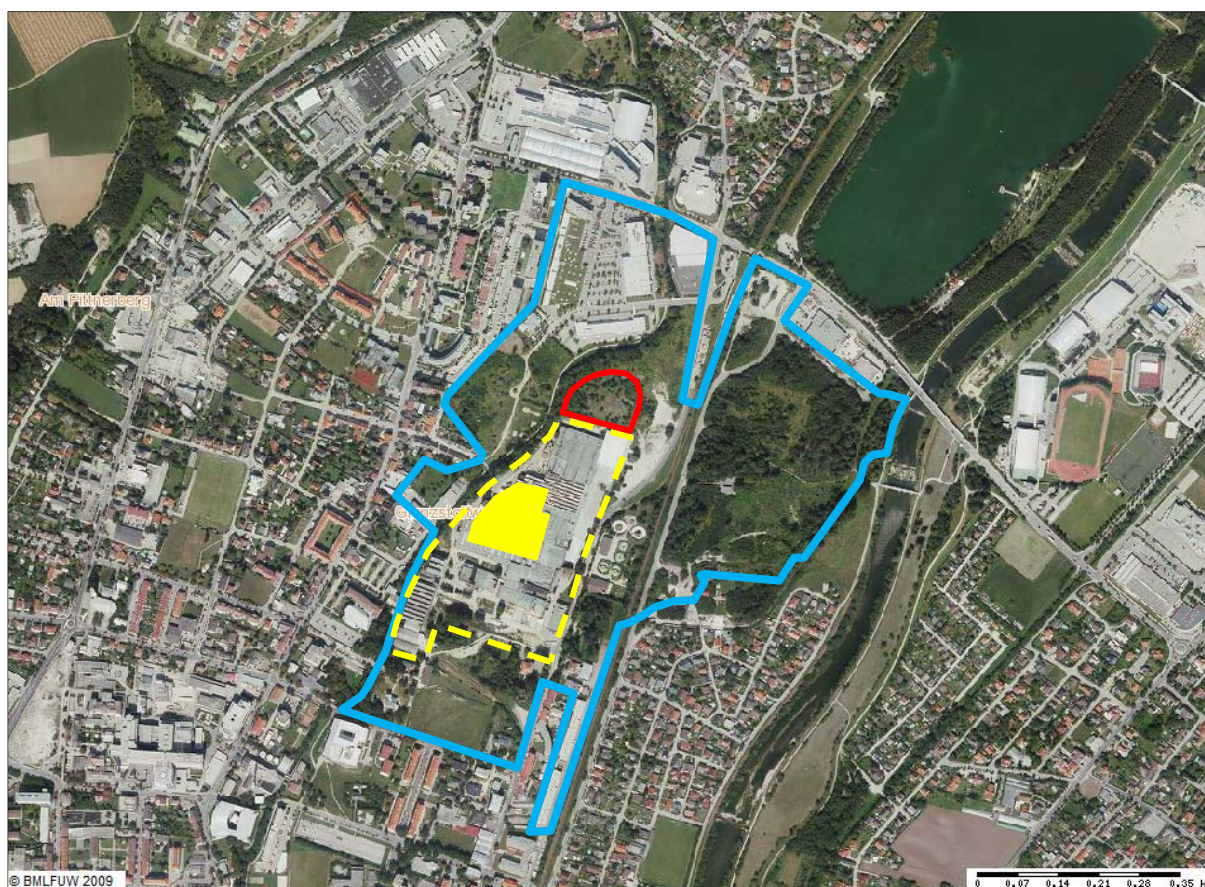
Abb. 2: Altstandort Glanzstoff Austria im Luftbild; Gesamtstandort (blau), Werksbereich (gelb strichliert), Teilbereich Spinnerei (gelb), Altlast N 35 „Glanzstoff – Deponie Nord“ (rot)
