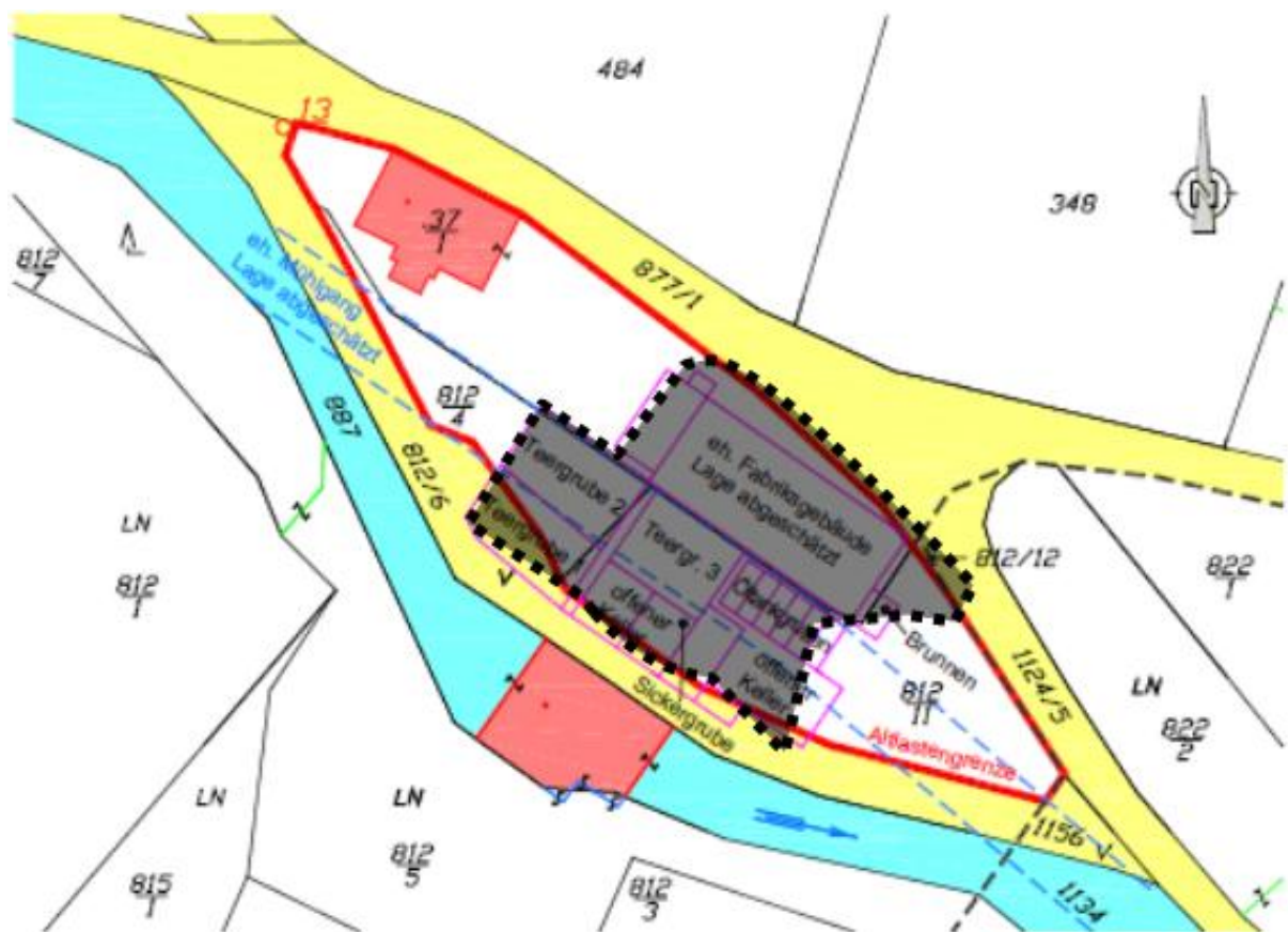
Abbildung 4: Abgrenzung des kontaminierten Untergrundbereiches (grau hinterlegt)
