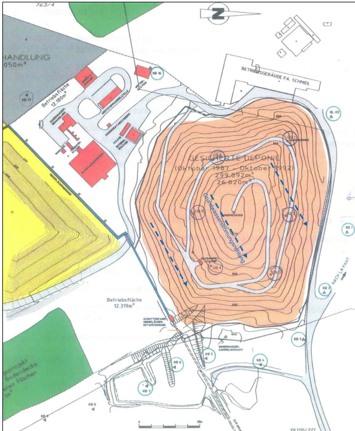
Abbildung 2: Umgebung der Deponie, Deponiegasbrunnen (GB) sowie Grundwasser messstellen (KB, B) und Grundwasserfließverhältnisse
