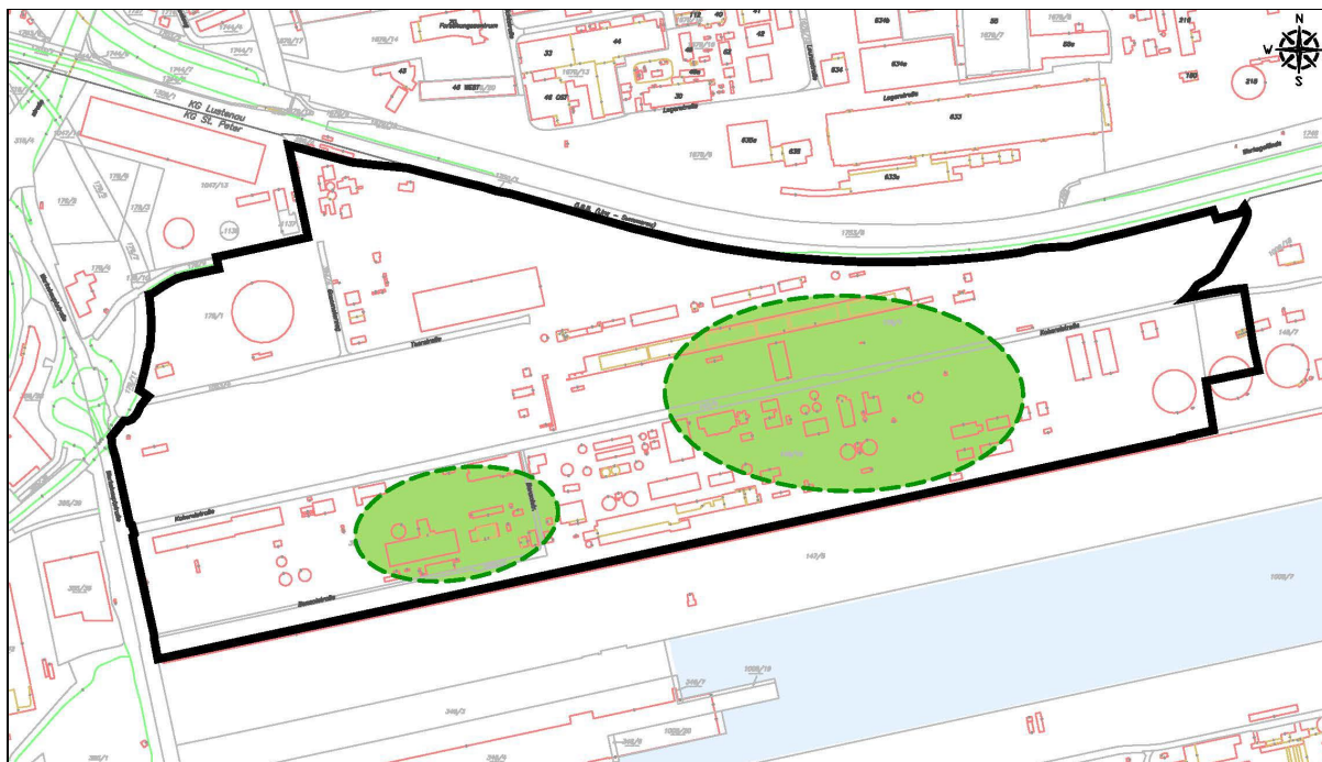
Abb. 15: Altlast O 76 „Kokerei Linz“ – Dekontamination der gesättigten Bodenzone durch Phasenabschöpfung (grün: Sanierungsfelder; © Umweltbundesamt GmbH)
