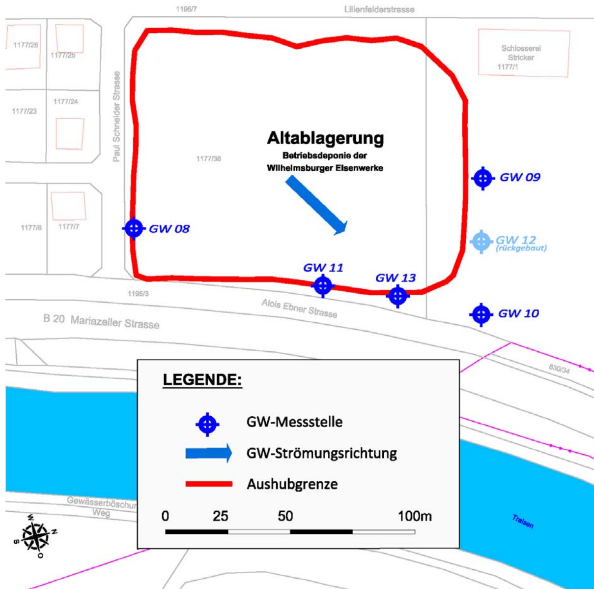
Abb.2: Aushubbereich und Lage der Grundwassermessstellen
