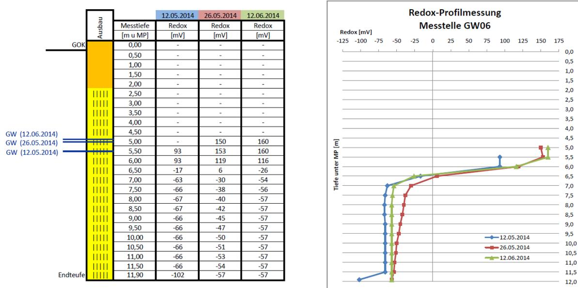
Abb. 13: Tiefenorientiert durchgeführte Redoxpotenzialmessungen und Auswertung an drei Terminen an z.B. der Messstelle GW-06
