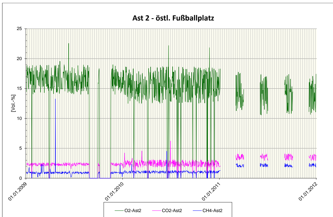
Abb. 5: Messergebnisse der Deponieentgasung – Absaugbereich 2
