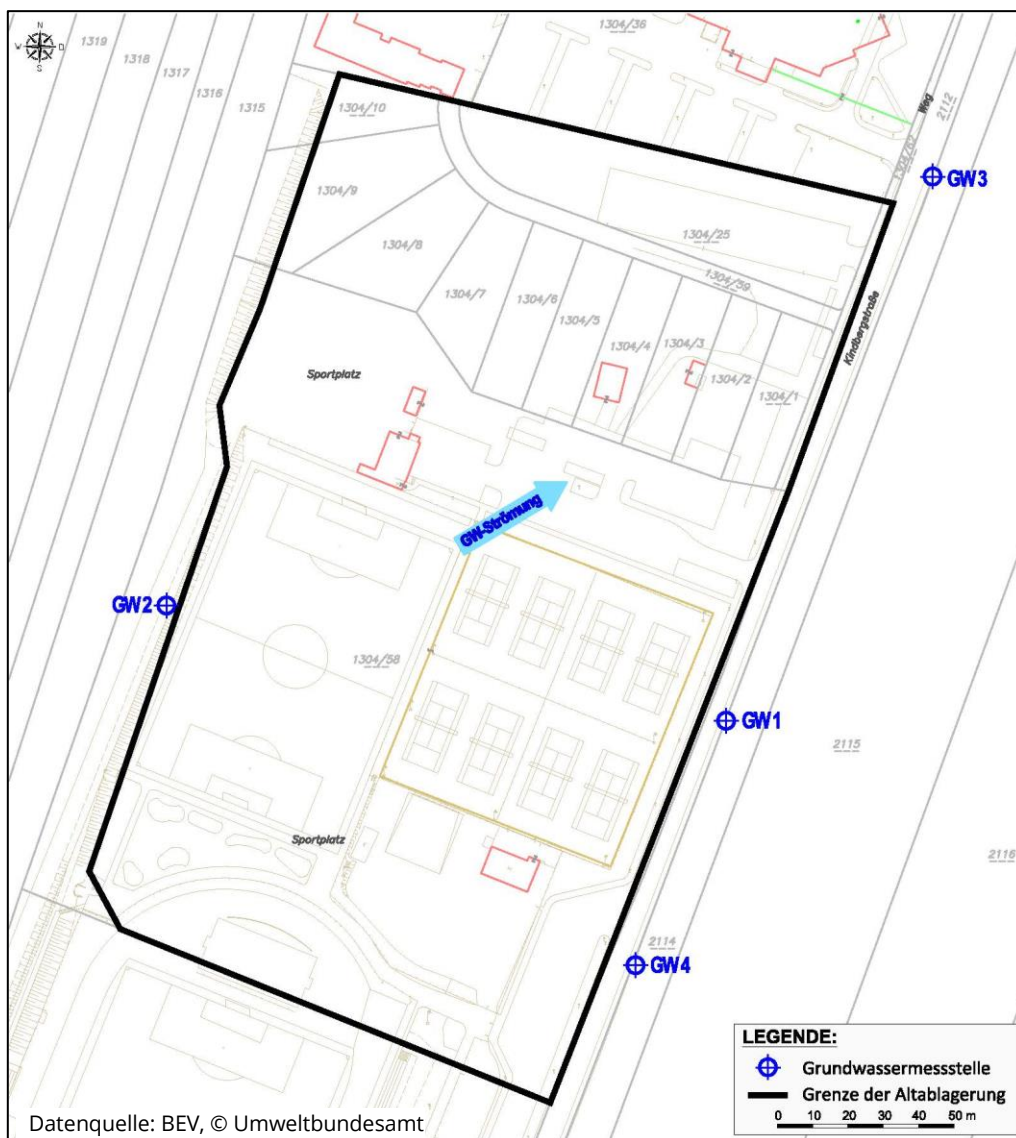
Abb. 9: Lage der Grundwassermessstellen, Grundwasserströmungsverhältnisse
