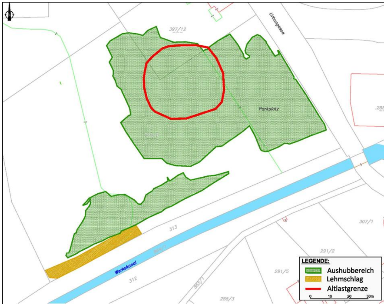
Abb. 3: Lage der Aushubbereiche
