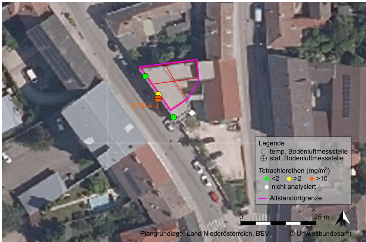
Abb. 4: CKW in temporären und stationären Bodenluftmessstellen
